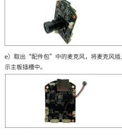
e) 取出“配件包”中的麦克风，将麦克风插入图示主板插槽中。
