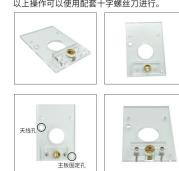
d) 取出“装配包”中三颗M2\*12螺柱以及三颗M2\*6螺丝，按照图示位置，使用螺丝将螺柱固定到亚克力底板上（特别提示：螺柱固定和下一步中支架板固定不在同一个面）。
